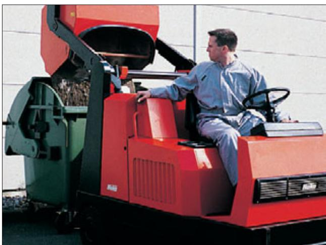
**Großer Schmutzbehälter:** Aus robustem Stahlblech. Fassungsvermögen 250 Liter oder 450 kg. Durch Überkopferwerfer-Prinzip 100%ige Befüllung möglich. Stufenlose, hydraulische Hochentleerung bis 1.520 mm direkt in die üblichen Standard-Müllcontainer.
