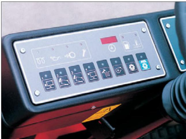
**Einfache und sichere Bedienung:** Mit nur einem Knopfdruck werden z.B. allekehrfunktionen über die „Grüne Hakomatic-Taste“ gestartet. Zusätzlich sind Reinigungsfunktionen individuell kundenspezifisch programmierbar. Fehlbedienung ist praktisch unmöglich.
