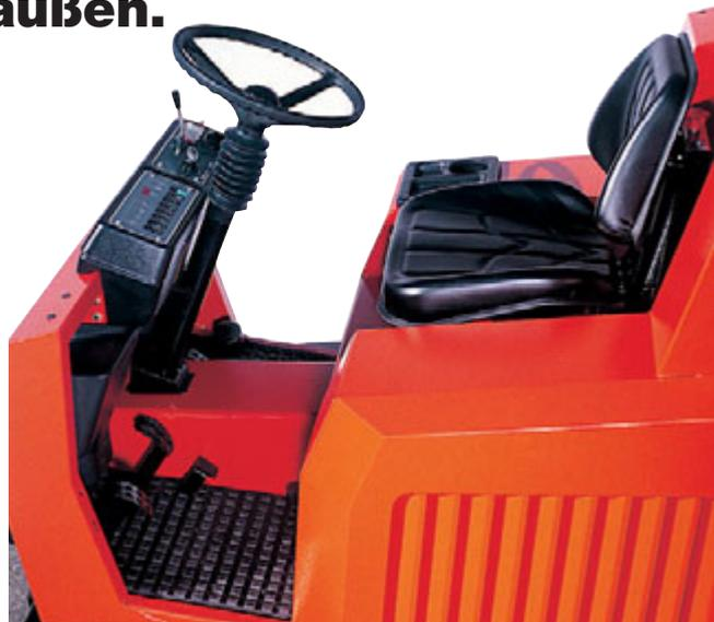
**Komfort-Arbeitsplatz:** Alle Bedienelemente im direkten Sicht- und Griffbereich. Hervorragende Sicht auf die Arbeitsflächen. Hydrostatischer oder elektrischer Fahrtrieb, leichtgängige Lenkung und der Komfort-Fahrersitz garantieren ermüdungsfreies Arbeiten.
