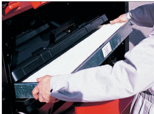
**Leistungsstarkes Filtersystem:** Hochwirksamer, verrottungsfreier Kassetten-Feinstaubfilter. Große Filterfläche von 5,6 m<sup>2</sup>. Abscheidegrad 99 %. Der Filter entspricht Klasse S der ZH 1/487. Elektrische Abrüttelvorrichtung mit programmierter Intervall-Reinigung und automatischer Saugluftabschaltung.
