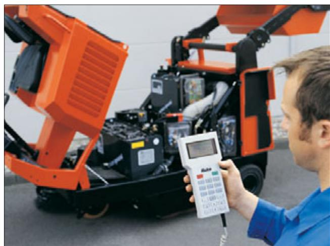
**Servicefreundlich:** Direkter Zugang zu allen wichtigen Aggregaten für Wartungs- und Pflegearbeiten durch voll aufklappbare Verkleidungen. Fehlersuche wird durch das integrierte Diagnosesystem beträchtlich erleichtert und drastisch verkürzt.
