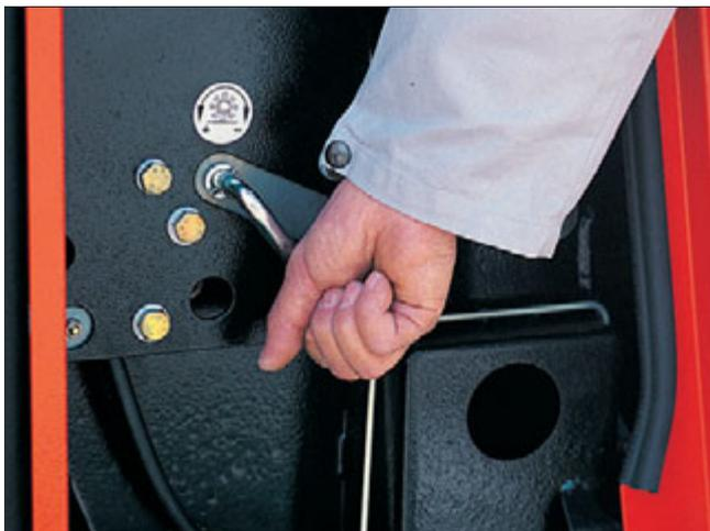
**Optimales Kehrerergebnis:** Durch einstellbare Behälternachführung findet ein Verschleißausgleich der Hauptkehrwalze statt, d.h. immer optimales Kehren. Die hohe Kehrgeschwindigkeit erlaubt Flächenleistungen bis 16.200 m<sup>2</sup> Sauberkeit/Stunde.
